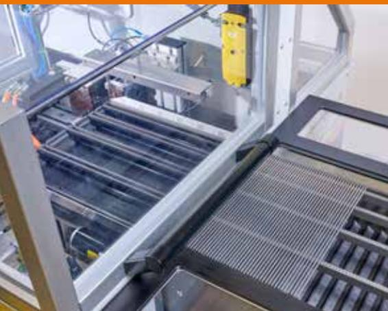
Rohlinge werden von Hand oder automatisiert in das Außenmagazin eingelegt
