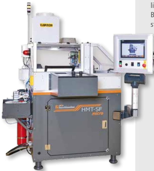
Die HMT-SF micro ist eine vollautomatisierte Anlage welche speziell für das Trennen und Anfasen von kleinsten Rundstäben aus verschiedensten Materialien (Hartmetall, HSS, Keramik, etc.) entwickelt wurde. Durch das komfortable Bestücken von außen, kann die Produktion fortlaufen und führt zu keinen Stillstandzeiten.
